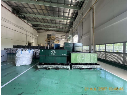
รูปถ่ายที่ 3.2-28 : ถังเหล็กขนาดใหญ่สำหรับเก็บรวบรวม Dross
